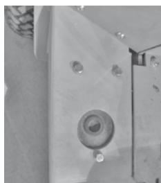
Sur les machines ayant la cabine L, le réservoir se trouve derrière la roue gauche avant et l'ouverture de remplissage est située sur le repose-pied.
