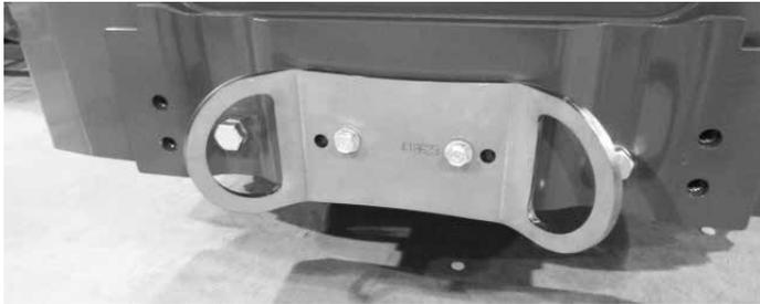
Attachez l'œillet d'arrimage réf. A418623 installé au pare-choc arrière ou au contrepoids
