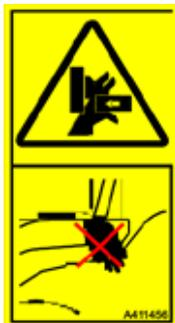
**Points de pincement** - Évitez le pincement entre le châssis du chargeur et entre le chargeur et les murs - Gardez toutes les parties du corps à l'intérieur du cadre de sécurité. Les mouvements du châssis articulé sont des sources de dangers de pincements. Gardez la tête, les mains et les pieds à l'intérieur du chargeur. Soyez particulièrement attentif lorsque vous conduisez près des murs et des arbres. Gardez les mains sur le volant et le joystick.
