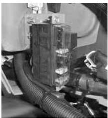
Sur une cabine DLX dotée d'une climatisation, des fusibles supplémentaires se trouvent dans la boîte à fusibles près du levier d'accélérateur et sont accessibles par le retrait du panneau de couvercle côté droit hors de la cabine.
