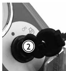
1. Tournez la clé du contacteur coupe-batterie en position ON
