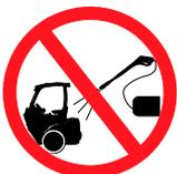
Ne pulvérisez jamais le compartiment du moteur ou les radiateurs avec une laveuse à pression. Les radiateurs de refroidissement et les équipements électriques, leurs connecteurs et isolants, ainsi que la batterie peuvent être endommagés. Utilisez de l'eau froide ou tiède pour laver les autres pièces du chargeur. N'utilisez jamais de l'eau chaude (au dessus de 70°C).
