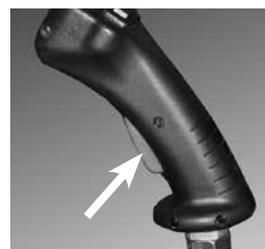
**Verrou en X engagé :** La valve anti-patinage régularise le débit d'huile entre les moteurs hydrauliques gauche et droit - toutes les quatre roues tournent de manière égale et permettent la meilleure traction possible.
