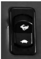
La plage de vitesse supérieure est destinée aux longs déplacements où une grande force de traction n'est pas nécessaire.
