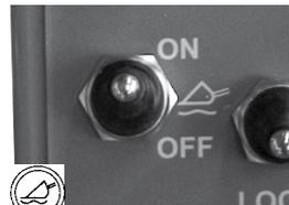
REMARQUE : L'interrupteur est installé sur le tableau de bord, également dans les cas où l'option de flottaison du bras de levage n'est pas installée sur le chargeur. La présence de l'interrupteur ne signifie pas que les options de flottaison du bras de levage ou d'entraînement en douceur sont fixées.
