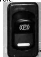
Le frein de stationnement s'engage automatiquement lorsque le moteur est arrêté. Le frein peut être relâché uniquement lorsque le moteur est en marche et qu'il y a de la pression hydraulique dans le système.
