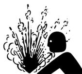
**Risque d'explosion de l'huile hydraulique - Isolez l'accumulateur hydraulique avant l'entretien** (Chargeurs équipés d'un système d'entraînement en douceur uniquement). Si le chargeur est équipé de l'option d'entraînement en douceur, un accumulateur de pression est fixé au circuit hydraulique du bras de levage. Ne déconnectez pas de composant hydraulique avant que l'accumulateur a été isolé du circuit et que la pression résiduelle a été relâchée.
