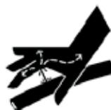
**Ne manipulez jamais des composants hydrauliques si le système hydraulique est sous pression - Risque d'injection de l'huile hydraulique à travers la peau.** Le liquide hydraulique à haute pression peut provoquer de graves blessures. N'utilisez jamais les mains pour rechercher les fuites. N'utilisez pas la machine si vous constatez un défaut dans le système hydraulique. Consultez immédiatement un médecin si le fluide hydraulique pénètre sous votre peau.
