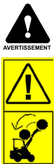
**Risque de chute d'objets - Assurez-vous que la charge est placée en toute sécurité sur l'accessoire.** N'inclinez jamais un accessoire pour le remettre en place lorsqu'il est élevé en hauteur. Assurez-vous que le chargeur est équipé des structures ROPS et FOPS qui sont en bon état et ne présentent pas des dommages visibles. Assurez-vous que l'accessoire est bien verrouillé.
