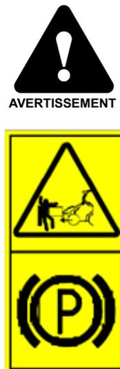
**Risque d'écrasement par un chargeur mobile - Engagez le frein de stationnement avant de travailler près du chargeur.** Suivez une procédure sécuritaire d'arrêt afin d'éviter tous les mouvements du chargeur. Évitez de laisser le chargeur en stationnement sur une colline. S'il est nécessaire de stationner sur une colline, utilisez des cales ou des moyens supplémentaires pour éviter que le chargeur se déplace.
