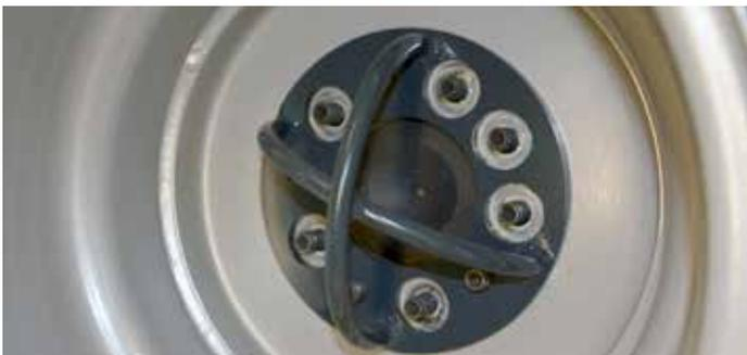
L'œillet d'arrimage sur le moyeu de la roue, réf. A423091
