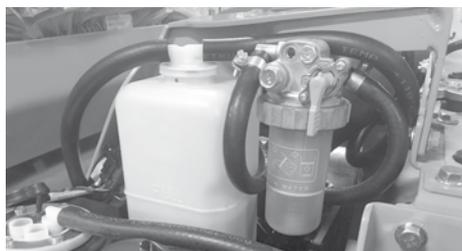
N'ouvrez jamais le radiateur sous pression, lorsque le moteur est chaud. Le liquide de refroidissement peut exploser et causer des blessures graves. Laissez le moteur complètement refroidir avant de l'ouvrir.
