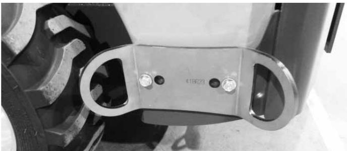
Attachez l'œillet d'arrimage réf. A418623 installé sur le côté du châssis arrière. Deux œillets sont nécessaires pour l'installation sur les côtés.
