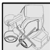
Ne conduisez pas avec la porte de la cabine ouverte, ni ne tournez pas le volant lorsque la porte de la cabine est ouverte. La porte peut se briser au contact avec les roues.
